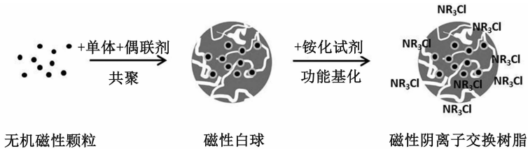
图 22 新型磁性阴离子交换树脂的制备过程 [122]
